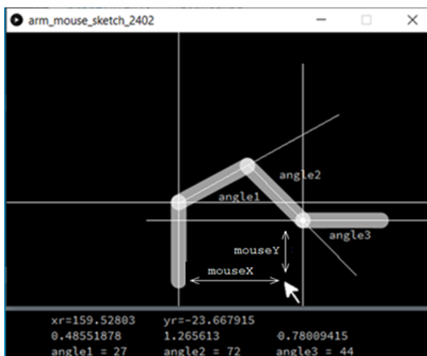
Рис. 13. Визначення координат робочого органу маніпулятора
